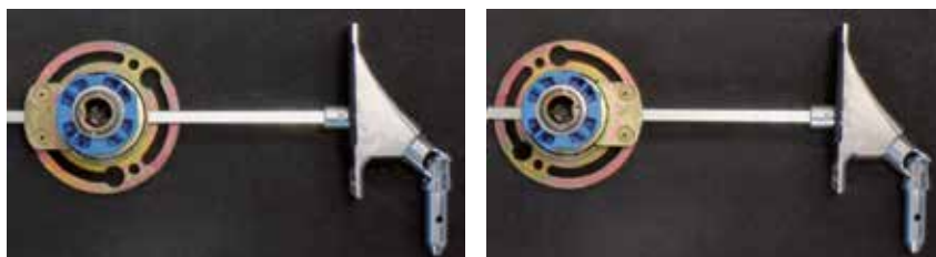
Treuil traversant à la manœuvre.
