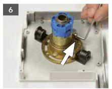
Die Schraube am Klemmblech (beidseitig schraubbar) mit einem 3 mm-Inbusschlüssel anziehen.
