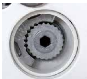
Photo 1: Les dents sont les unes sur les autres.
