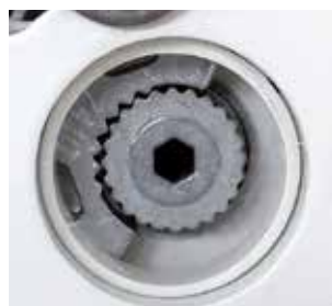
Photo 2: En enroulant le store banne, les dents s'imbriquent les unes dans les autres.
