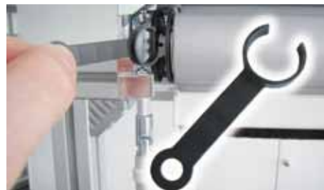
Ecarter le système PROTECTOR de la plaque d'entraînement et mettre en place l'outillage de réglage
