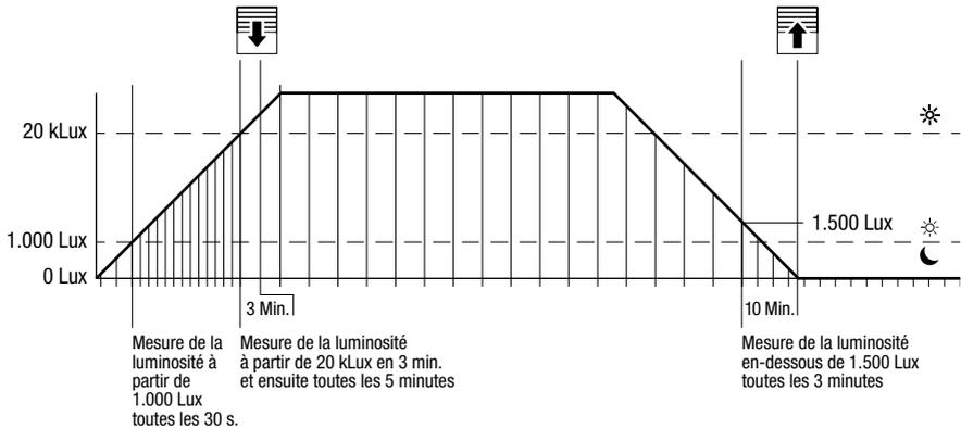
Lorsque le capteur est activé, la luminosité est mesurée. Si la luminosité est inférieure à 1000 Lux, le capteur passe en mode nuit, sinon il se trouve en mode jour.
