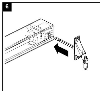
Introduisez la tige de sortie de la sortie de coffre étanche à l'air par le trou dans le treuil. Vissez la sortie de coffre au mur avec 2 vis (non fournies).
