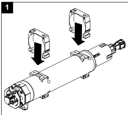
Contrôlez la bonne fixation de l'embout débrayable. Faites glisser les tampons sur le moteur jusqu'à ce qu'ils s'enclenchent bien sur les pieds de montage.
