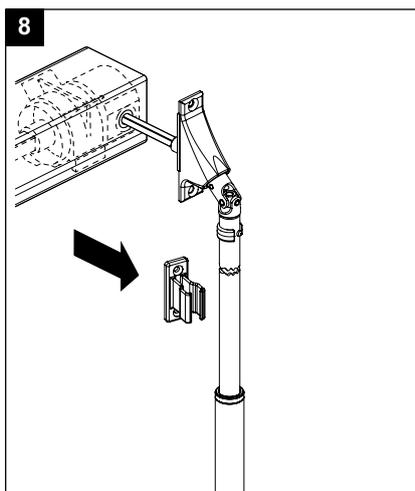
Fixez le support de manivelle au mur à l'aide de 2 vis (non comprises dans la livraison).
