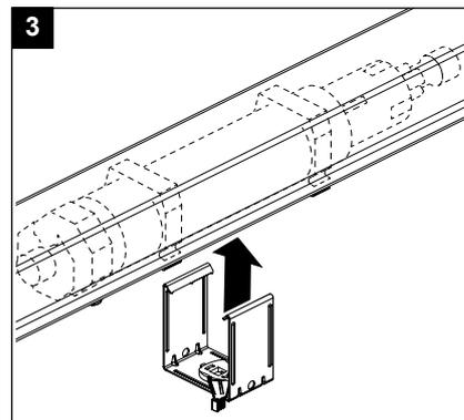
Pour sécuriser le moteur, faites glisser l'étrier de serrage sur les rails supérieurs. Insérez les barres de retournement dans les pièces d'accouplement.
