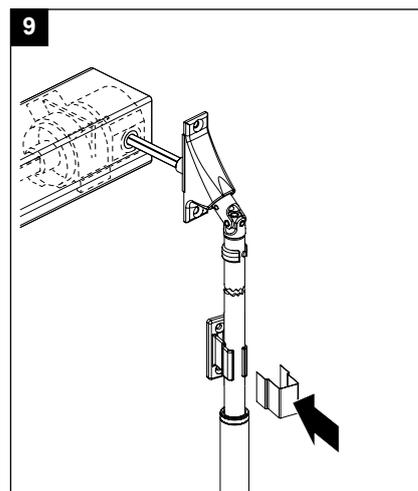
Sécurisez la manivelle avec le sceau de sécurité en le collant sur le support.
