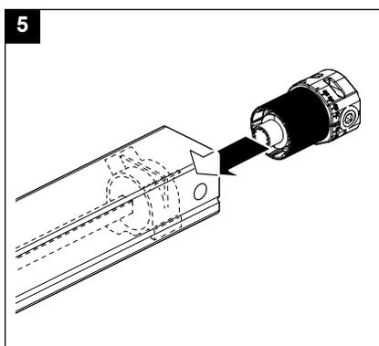
Poussez le treuil dans le support et bloquez le treuil avec la vis par le dessous.
