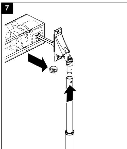
Faites glisser la manivelle sur le tourillon de la sortie de coffre et la fixer avec le clip de sécurité fourni.
