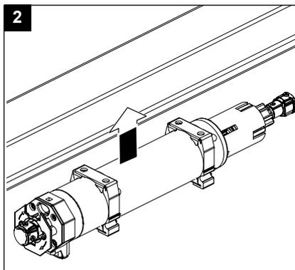
Faites glisser le moteur avec les tampons dans le rail supérieur.
