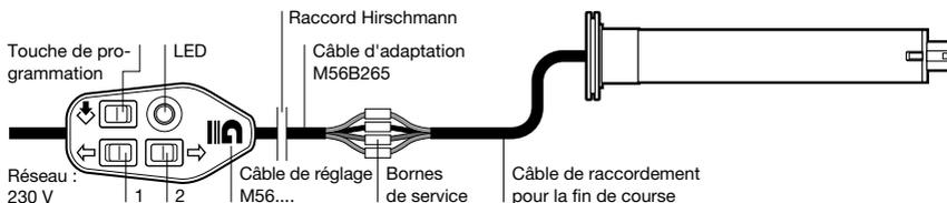
Raccorder le câble de réglage au câble de raccordement du **GU45..E02** en veillant à toujours connecter ensemble les fils de la même couleur. L'attribution des touches 1 et 2 indiquant la direction dépend du sens dans lequel le moteur a été installé. Brancher ensuite le câble de réglage sur le réseau 230V.
