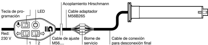
Acoplar el cable de ajuste al cable de conexión del motor, conectando siempre entre sí los conductores del mismo color. La asignación de las teclas de dirección 1 y 2 con respecto al sentido de giro depende de la posición de montaje del accionamiento. A continuación, conectar el interruptor de ajuste a la red de 230V.
