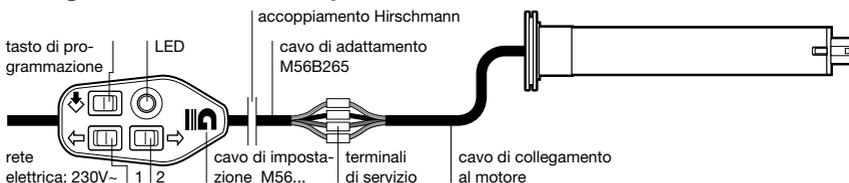
Collegare il cavo di impostazione al cavo di collegamento del motore. Nel fare ciò, si prega di collegare sempre i morsetti dello stesso colore. L'assegnazione dei tasti direzionali 1 e 2 alle direzioni di rotazione dipende dall'installazione del motore. Quindi, collegare il cavo di impostazione alla rete elettrica a 230 V.
