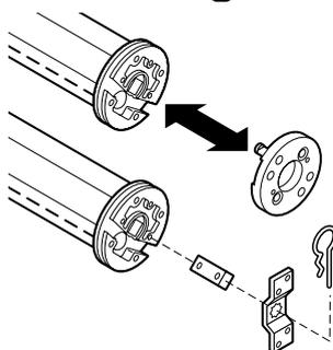
**A seconda della testa motore selezionata, possono essere utilizzati diversi sistemi di fissaggio:**
