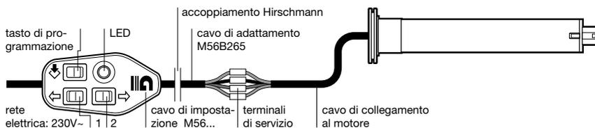
Collegare il cavo di registrazione al cavo di raccordo del motore, facendo sempre corrispondere le trecce in base al colore. L'abbinamento dei tasti di direzione 1 e 2 per il senso di rotazione dipende dalle condizioni di montaggio del motore. Collegare quindi l'interruttore di regolazione alla rete da 230V.
