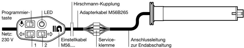
Einstellkabel an die Anschlussleitung des Motors anschließen, dabei immer die Adern farbengleich miteinander verbinden. Die Zuordnung der Richtungstasten 1 und 2 zur Drehrichtung ist von der Einbausituation des Antriebs abhängig. Dann den Einstellschalter mit dem 230V-Netz verbinden.
