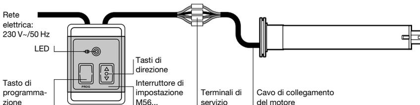
Collegare il cavo di impostazione al cavo di collegamento del motore (vedere lo schema sul retro dell'interruttore di impostazione). L'assegnazione alla direzione di rotazione dipende dalla tipologia di installazione del motore. Quindi, collegare il cavo di impostazione alla rete elettrica a 230 V.
