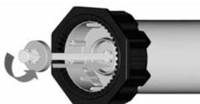
\* Per tutti i sistemi di disinserimento a finecorsa elettronici e radiocomandati come GEIGER Easy (GR45..E01), GEIGER SoftPerfection (GR45..E03), GEIGER SoftPerfection-S (GR45..E04) e GEIGER VariousWireless (GR45..F01) è necessario inserire anche l'albero magnetico M45B033 nel motorino tubolare.
