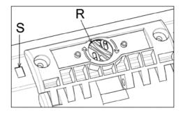
Attenzione: quando si gira il sistema di blocco R, si sentono le clip scattare in posizione.
