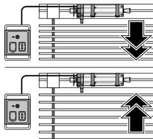
Le processus de réglage est à recommencer pour le réglage d'une nouvelle fin de course. La prise de référence est activée automatiquement si la position supérieure est programmée. **Remarque:** lors de la prise de référence, le moteur passe au-dessus de la position supérieure réglée et continue jusqu'à l'interrupteur de fin de course ou s'arrête par déconnexion du couple.
