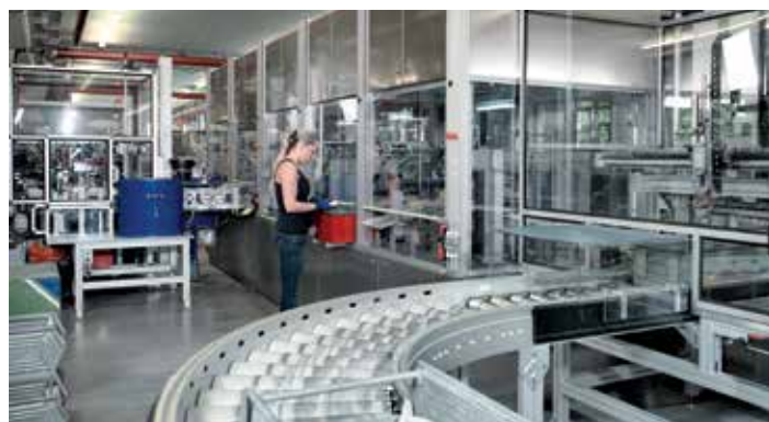
Co 3,5 sekundy jedna korbka jest składana z 12 komponentów
