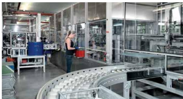
Ogni 3,5 secondi viene assemblata un'asta di manovra costituita da 12 componenti
