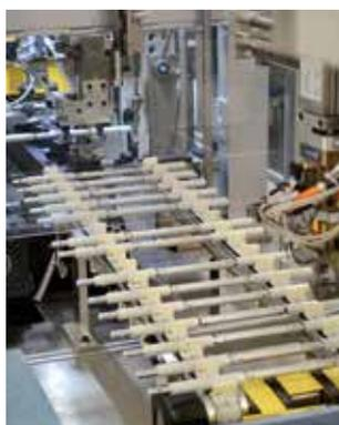
Aste di manovra assemblate alla fine della catena di montaggio
