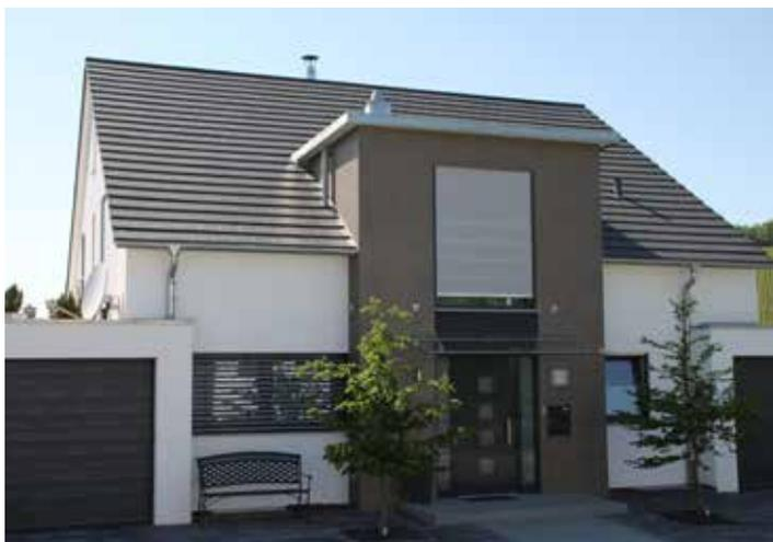
*Automatische Beschattung: Der Standort des Hauses wird mit Längen- und Breitengrade, die Ausrichtung der Fenster mittels Kompass bestimmt. Auf diese Weise kann die Beschattung auf Sonnenaufgang und -untergang, und auf den Sonnenstand reagieren. Zusätzlich können noch Wetterdaten für den Standort eingebunden werden.*
