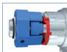
Umschaltmechanismus nach rechts bis zum Anschlag drehen ...
