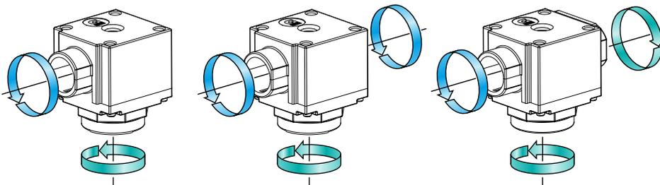
**Treuil renvoi d'angle avec une manœuvre et une sortie.**
