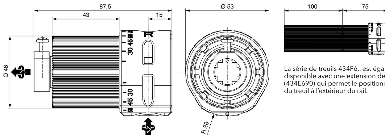
La série de treuils 434F6.. est également disponible avec une extension de boîtier (434E690) qui permet le positionnement du treuil à l'extérieur du rail.
