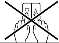
Keine Schalter die einen gleichzeitig AUF- und AB-Befehl zulassen verwenden!
