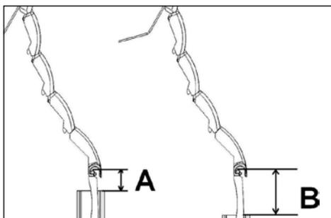
La barra guía superior de la persiana no debe sobresalir menos de 1/3 de la altura del perfil **A** y no más de 2/3 de la altura de perfil **B**, con respecto al riel de guía.
