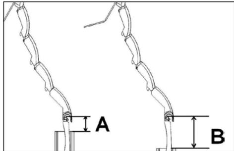
Der oberste Profilstab des Rollladens darf nicht weniger als 1/3 der Profilhöhe **A** und nicht mehr als 2/3 der Profilhöhe **B** aus der Führungsschiene herauskommen!
