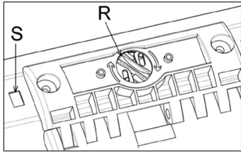
**Achtung, durch Wenden des Schlitzes R rastet die Sicherung hörbar ein!**
