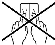
Ne jamais appuyer simultanément sur les touches HAUT et BAS car cela pourrait détruire le moteur. Avec le système BUS veuillez respecter un temps de commutation de 500 ms.
