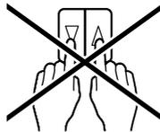
Ne pas utiliser d'interrupteur permettant une commande simultanée des touches HAUT et BAS. Avec le système BUS veuillez respecter un temps de commutation de 500 ms.
