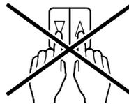
Niemals gleichzeitig AUF- und AB-Taste betätigen, da dies den Motor zerstören kann. Bei einem Bussystem ist eine Umschaltzeit von 500ms einzuhalten
