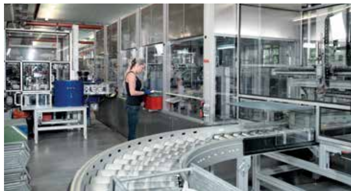
Toutes les 3,5 secondes une manivelle articulée est assemblée à partir de 12 éléments
