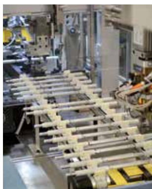
Manivelas recién montadas saliendo de la estación de montaje
