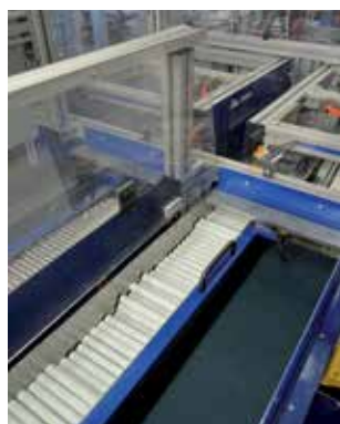
Preparación de las empuñaduras para el montaje
