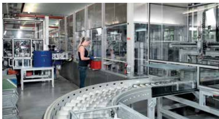
Cada 3,5 segundos una manivela es producida compuesta por 12 diferentes piezas
