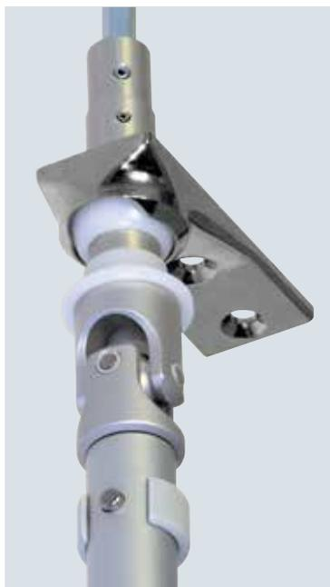
Lors de l'installation de la sortie de coffre pour volets roulants et stores vénitiens, on rencontre parfois des situations où une manivelle fixe ne peut être apposée – par exemple, parce qu'elle empêcherait tout simplement l'ouverture de la fenêtre. Le système GEIGER de manivelle amovible permet ici de retirer la tige de manivelle directement au niveau de la plaque de la sortie de coffre. Une petite tulipe y est intégrée discrètement pour faciliter l'insertion de la tige de manivelle.
