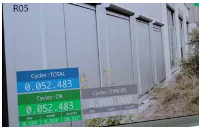
Fernüberwachung eines Rollladenprüfstandes – Qualität zahlt sich aus. Teilweise laufen Motoren 10 mal so lange wie nach DIN gefordert.
